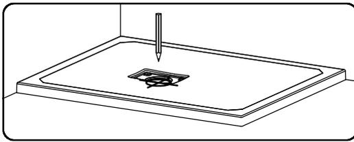
Tracer la position de la bonde et réaliser un montage à blanc de la bonde et du receveur
