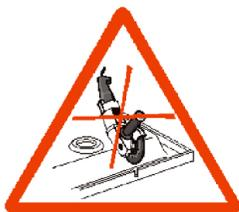
Le receveur ne doit subir aucune modification (sciage, meulage de renfort...) autre que celles prévues par le fabricant.
