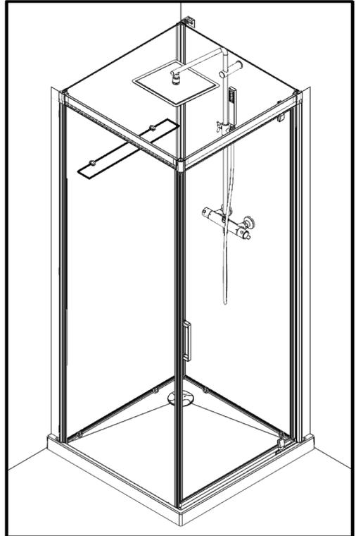
**FR** Vous avez la possibilité de réaliser un montage à droite ou un montage à gauche. Notre notice d'installation décrit un montage à droite. Si vous voulez réaliser un montage à gauche, il vous suffit d'inverser le montage.
