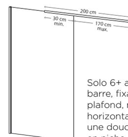
Solo 6+ avec barre, fixation au plafond, montage horizontal dans une douche en niche
