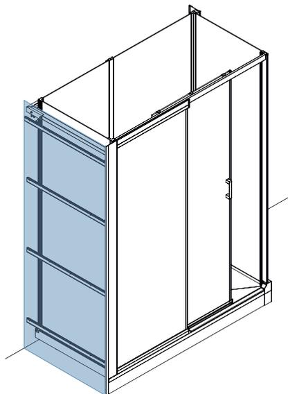
Baguette de finition latérale (pour les modèles d'angle hauts)
