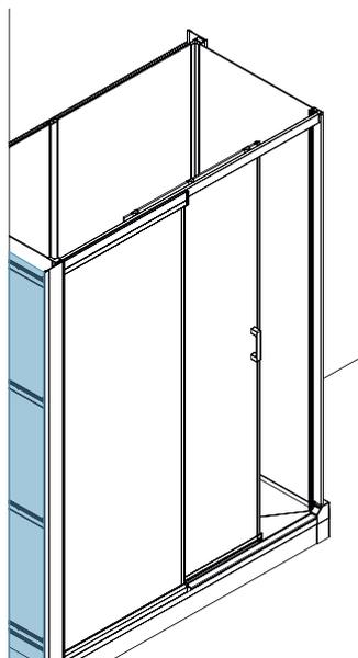
Kit de fixation pour montage mural uniquement pour les modèles hauts (Permet l'installation d'un système Kinemagic sur un mur unique. La zone bleue est revêtue de panneaux muraux.)
