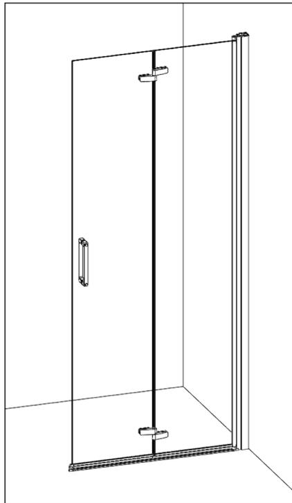
**F** Vous avez la possibilité de réaliser un montage à droite ou un montage à gauche. Notre notice d'installation décrit un montage à gauche. Si vous voulez réaliser un montage à droite, il vous suffit d'inverser le montage.
