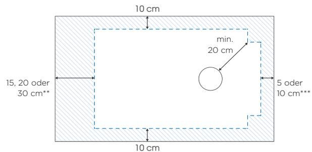
Maximaler Schneidebereich (wenn die Duschwanne nicht vollständig in den Boden eingelassen ist, müssen die abgeschnittenen Seiten an den Wänden anliegen)
